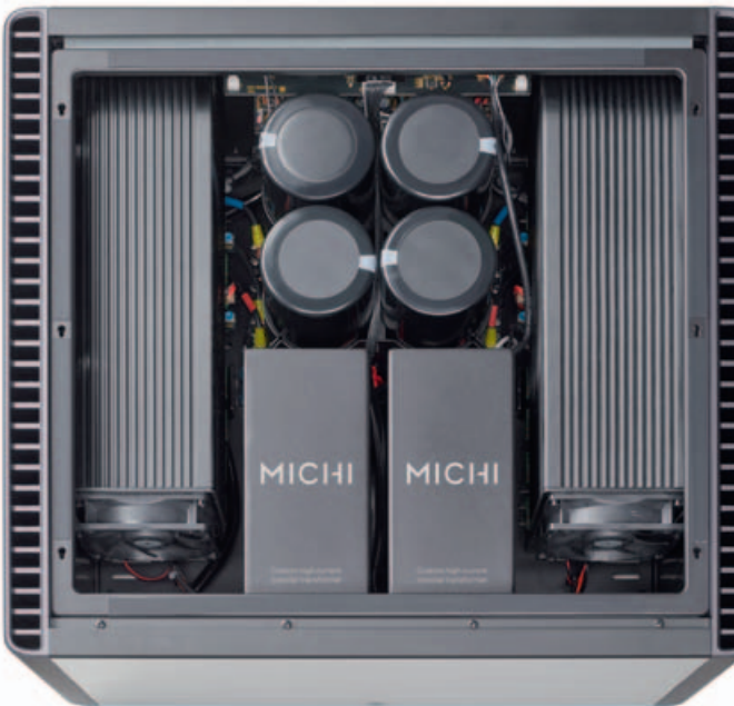
Blitzsauber: Die Amps der Michi-Serie sind auf Spiegelgleichheit getrimmt. Selbst der Strom kommt über zwei getrennte Netzteile.
